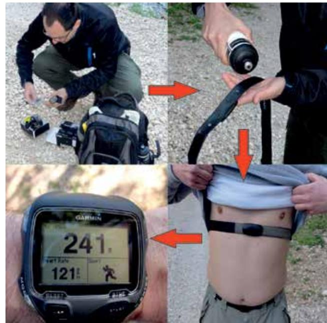
Slika 2. Postavljanje uređaja Garmin F910 za mjerenje frekvencije srca (foto: I. Martinić)
